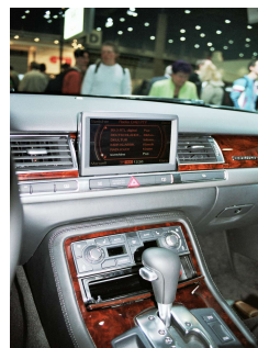
Eingebauter DAB-Tuner im Multi Media Interface des neuen Audi A8
